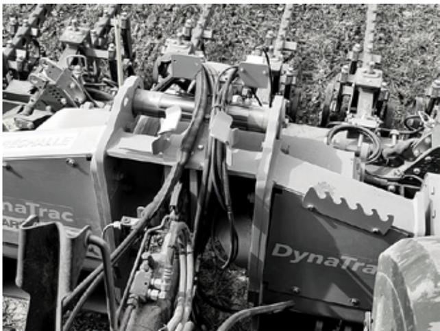
↳ Laforge propose une interface garantissant un positionnement répétable et précis de l'outil, quelle que soit l'opération effectuée
