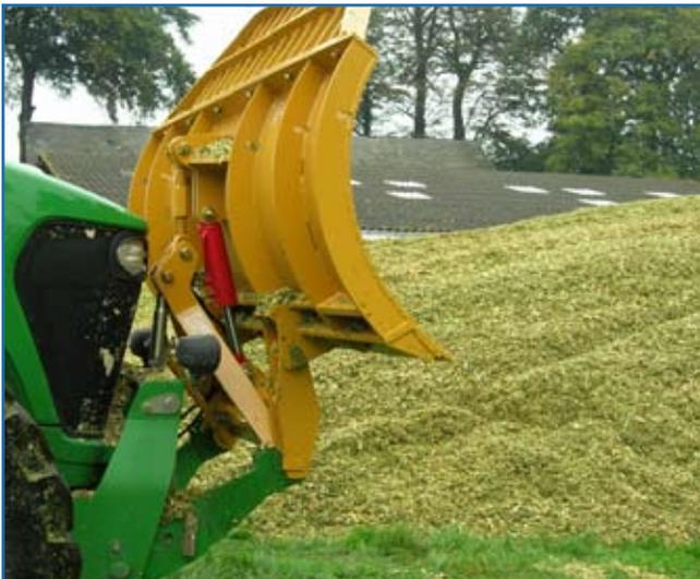
Lame surélévatrice en position haute (option réhausse ensilage)
