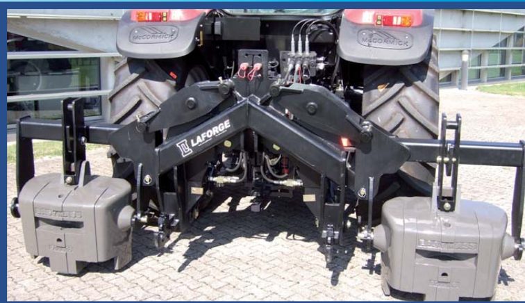
En position basse du FLEXIMASS® 2-étages (relevage baissé) pour atteler ou dételé les masses.
