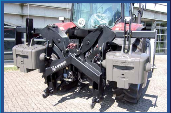
En position haute du FLEXIMASS® 2-étages (relevage baissé)
